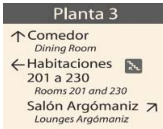
Figura 19. Muestra de señalización direccional con referencia al número de planta, situada en la parte superior de la señal.
