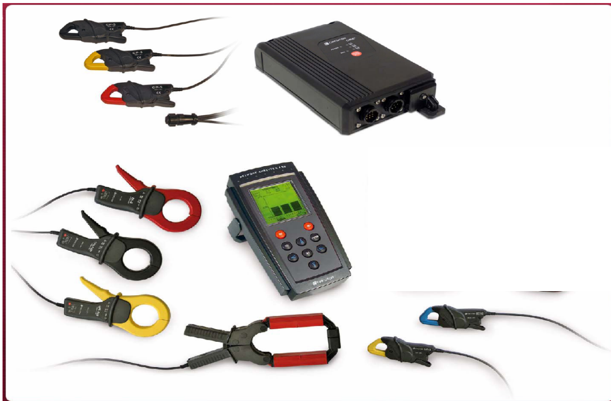
Figura 3. Analizador de redes circuitor AR-5
