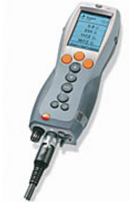
Figura 8. Equipo analizador gases combustión.
