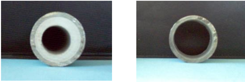
Figura 74. Imagen conducto antes y después de limpieza química
